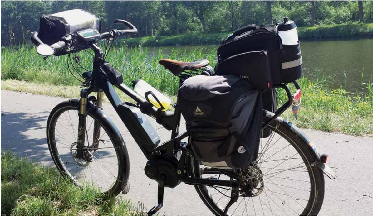
Das Rad: Riese & Müller Delite Touring eBike mit Gepäcktaschen und der KlickFix-Tasche auf dem Gepäckträger. Ausgestattet mit Bosch Performance CX Motor, 500 Wh Akku und Bosch Nyon Computer, 14-Gang Rohloff Nabenschaltung und Shimano Deore XT Scheibenbremsen. „Unplattbar“-Reifen sollen vor Platten bewahren.
