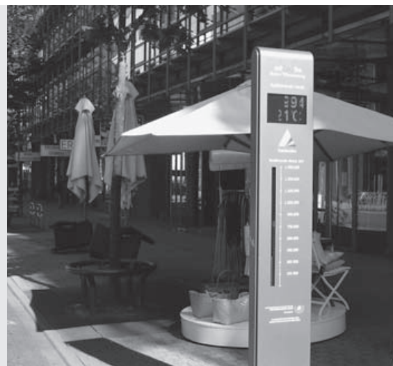
Zählstelle mit Displayanzeige auf einer Radroute in der Karlsruher Innenstadt
