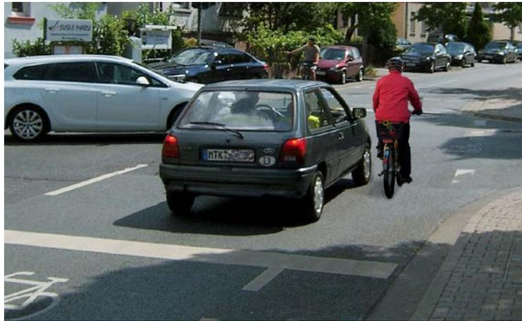
Diese Fotomontage zeigt, wie eng es am Ende eines Fahrrad-schutzstreifens werden kann, wenn die Schutzzone abrupt endet und der parallel fahrende Pkw-Fahrer den vorausfahrenden Radfahrer gefährlich schneidet
