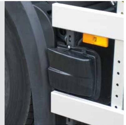
Unter dieser unscheinbaren schwarzen Abdeckung an der rechten Seite des Fahrzeuges arbeitet der Abbiegeassistent.
