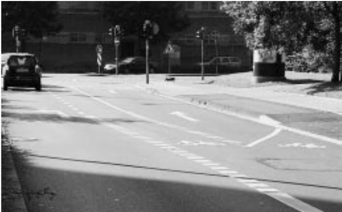
**Bild 1:** 1,5 Meter breiter Schutzstreifen für direktes Linksabbiegen in der Ernst-Kahn-Straße
