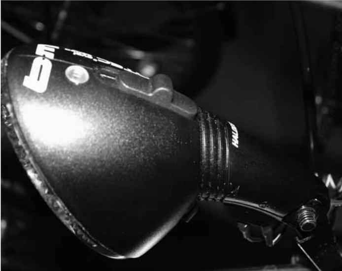
Die Lampe mit Schalter zur manuellen Inbetriebnahme und Sensor (links neben dem Schalter) für den vollautomatischen Betrieb. Unten rechts sind die noch falsch (oder richtig?) angeschlossenen Kabel des Rücklichts zu sehen.
