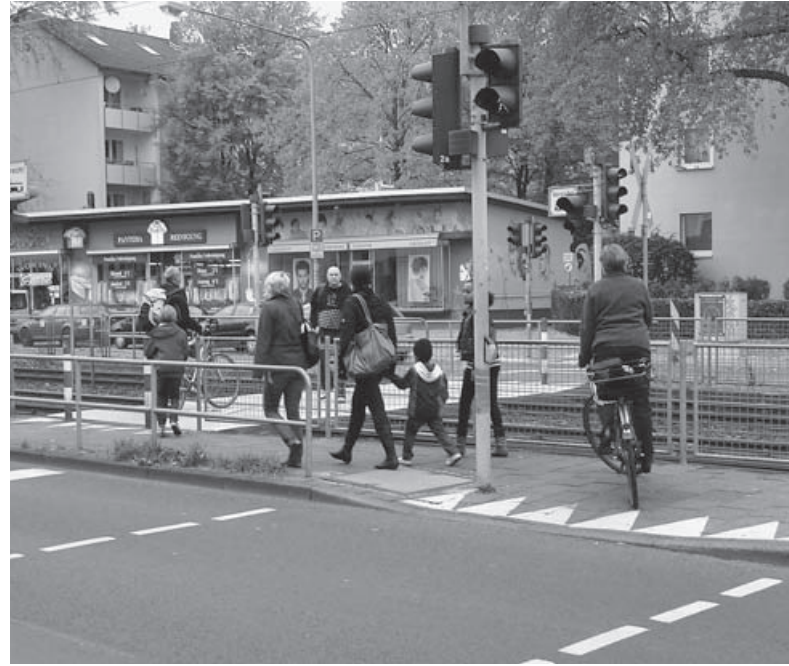
Warum Umlaufsperrern auch Drängelgitter heißen – Fußgängerüberweg im Z-Design der 60er-Jahre an der Eschersheimer Landstraße
