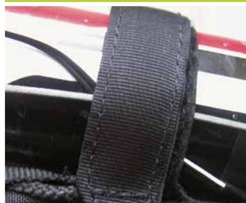
Hier verläuft das Bremsseil gemeinsam mit dem Lampenkabel am Oberrohr. Wenn die Schlaufe der Werkzeugtasche zu fest angezogen wird, kann die Rückholfeder überfordert sein. Das »
