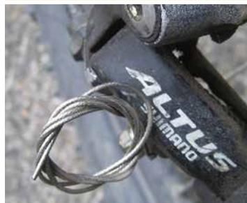
Für den Fall, dass am oberen Ende Material für einen Knoten benötigt wird, ist es gut, am unteren Ende etwas Reserve zu haben. Hier am Schaltseil, das natürlich auch mal reißt.
