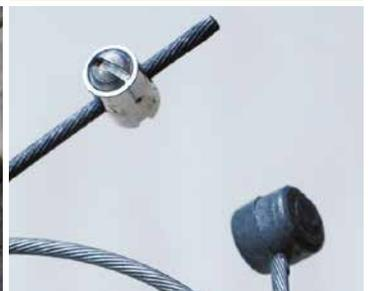
Ein paar Schraubnippel in der Werkzeugtasche können nicht schaden. Hier sitzt der Schraubnippel an einem kurzen Querseil, dessen Länge einstellbar sein soll.
