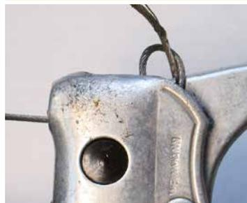
Im Notfall ersetzt ein Knoten den abgerissenen Nippel. Das ist besser, als mit nur einer Bremse nach Hause zu fahren.
