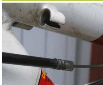
» Bremsseil blockiert dann auf dem Rückweg, der Bremsgriff wird locker ... und das Bremsseil springt aus seiner Halterung. Beim nächsten Bremsen greift man dann ins Leere.
