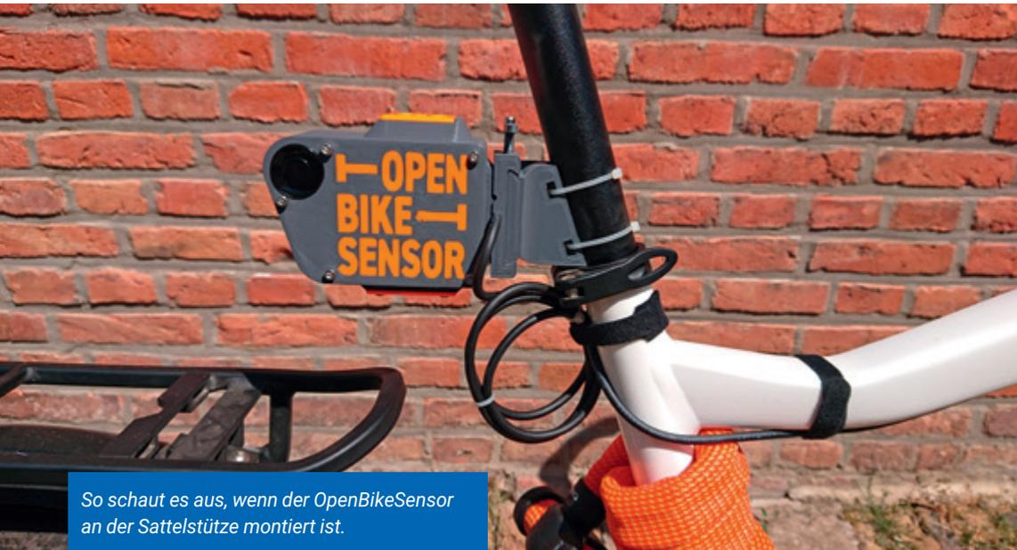
So schaut es aus, wenn der OpenBikeSensor an der Sattelstütze montiert ist.
